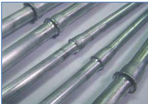
*Sostituzione della fiamma per la brasatura di un radiatore per aria condizionata. Si usano anelli di lega di brasatura con il disossidante incluso. Un induttore "split-helical" facilita l'inserimento e l'estrazione del pezzo. 5kW a 260kHz, 565°C in 12 secondi.*
